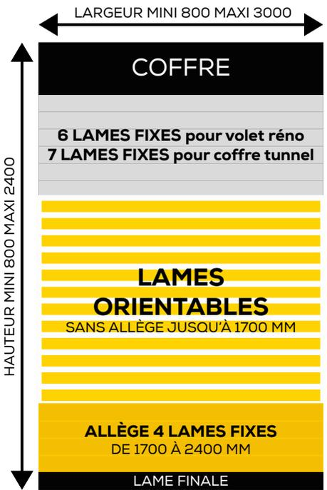
Son tablier est composé de **LAMES FIXES** et de **LAMES ORIENTABLES**. Les lames fixes, en partie haute et basse, donnent une grande rigidité au tablier et permettent de réaliser une allège dont la hauteur est au choix du client (minimum 4 lames).
